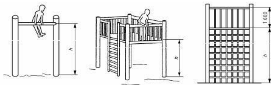
29.attēls. Brīvā krišanas augstuma noteikšanas piemēri (avots: Standarta LVS EN 1176-1:2008 14.attēls)
