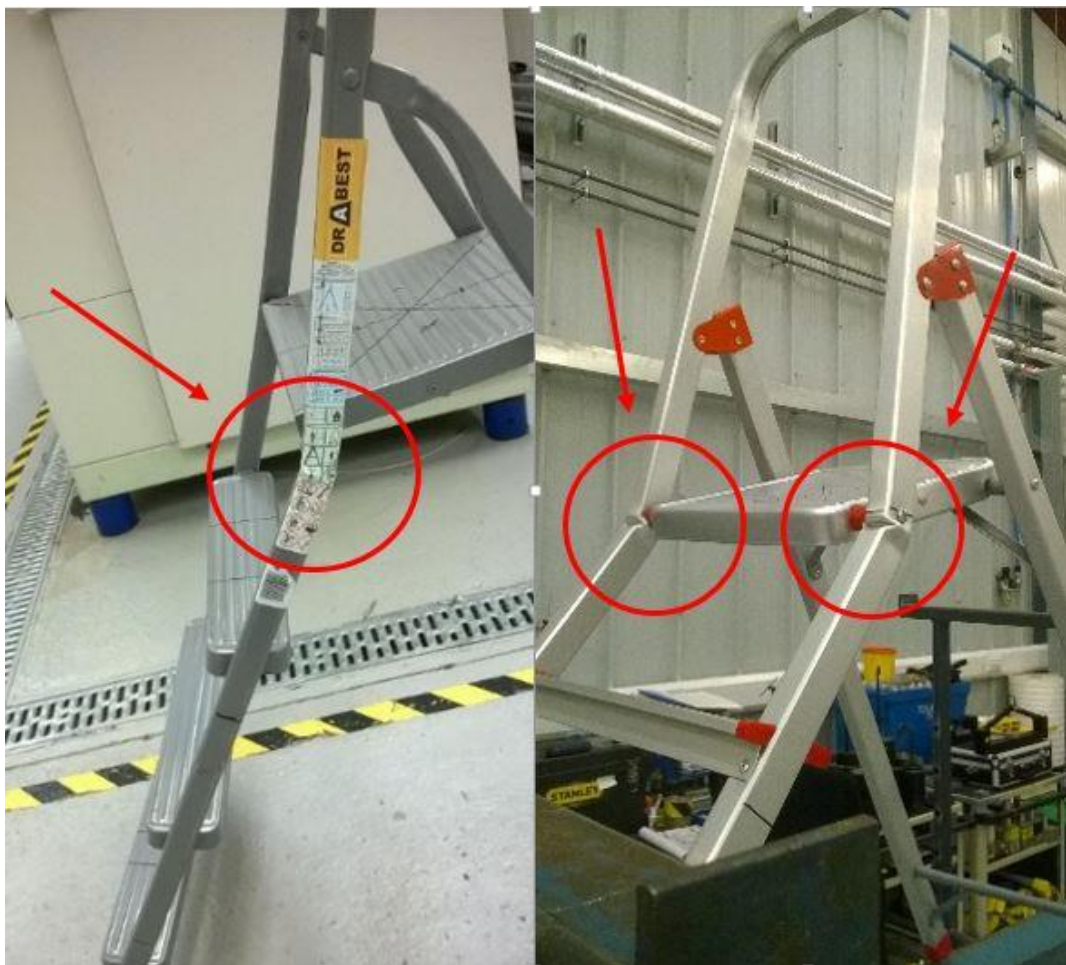
3.att. Kāpnes balstu deformācijas pēc testēšanas
